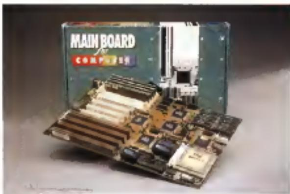
Infine c'è un prodotto per Intel DX4, la 486VP Pci/Vesa che ha 4 slot Pci, due slot Vesa e due slot ISA a 16 bit,
